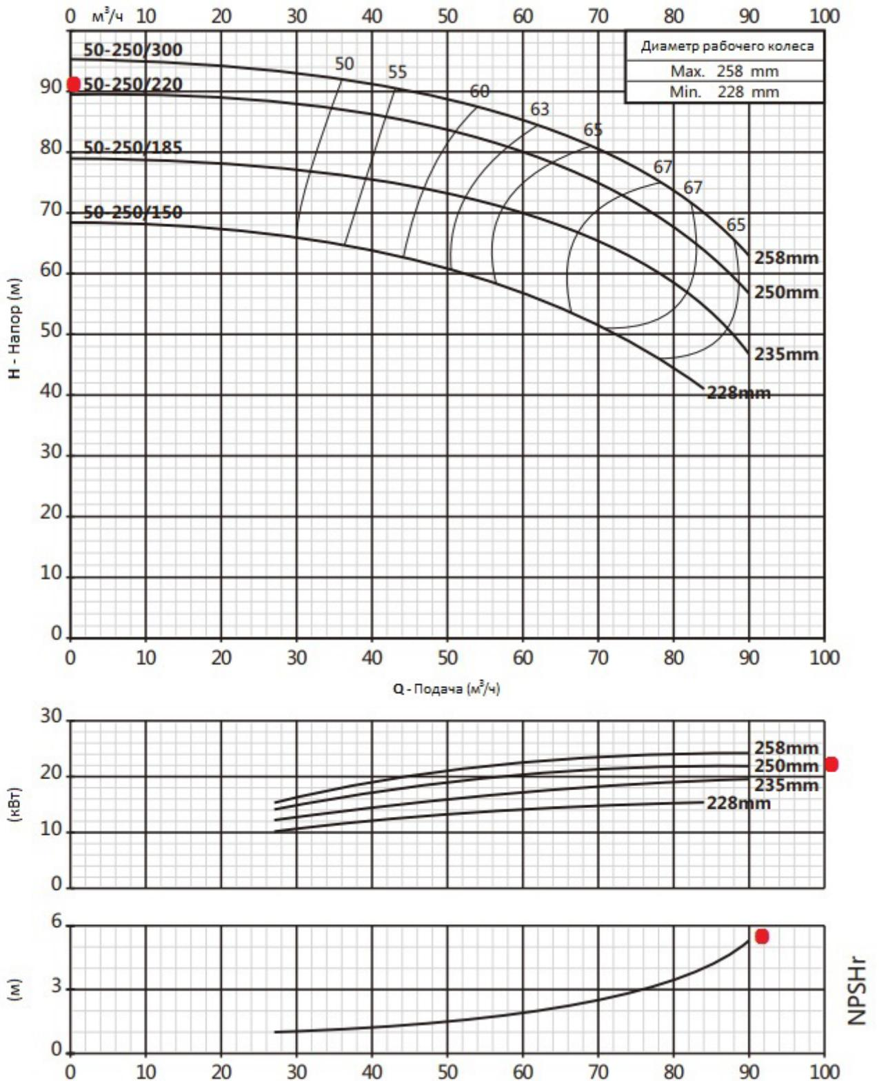
Пояснение к графикам: Н – напор в м.в.с., Q – подача в м<sup>3</sup>/ч, NPSHr – потери давления на всасывании, кВт – потребляемая мощность в кВт. Измерения проводились для чистой воды, температурой 20°С и вязкостью 1 мм<sup>2</sup>/с
